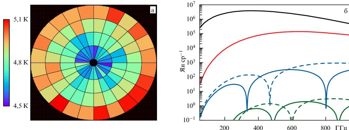
**Рис. 6.** (В цвете онлайн.) (а) Распределение температуры по поверхности первичного зеркала. 96 панелей имеют различную температуру, которая может увеличиваться от центра к краю на 0,5 К. (б) Вклад от излучения зеркала в общий сигнал. Моменты разложения сигнала  $\gamma_n B_n$ : чёрный  $n = 0$ , красный  $n = 2$ , голубой  $n = 3, 4$ , зелёный  $n = 5, 6$ . Штриховыми линиями указаны нечётные моменты ( $n = 3, 5$ ).
