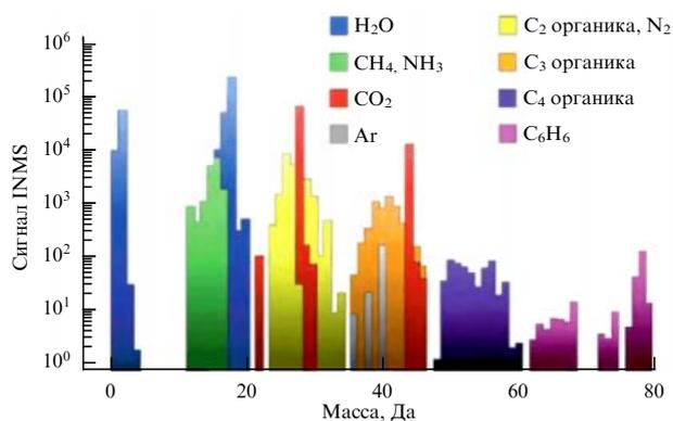
**Рис. 21.** (В цвете онлайн.) Спектр масс для шлейфа Энцелада, измеренный с помощью ионного и нейтрального масс-спектрометра (INMS) во время пролёта КА NASA Cassini 9 октября 2008 года. Цвета на рисунке показывают вклад от различных химических соединений и их возможных фрагментов. (Рисунок заимствован из работы [320].)
