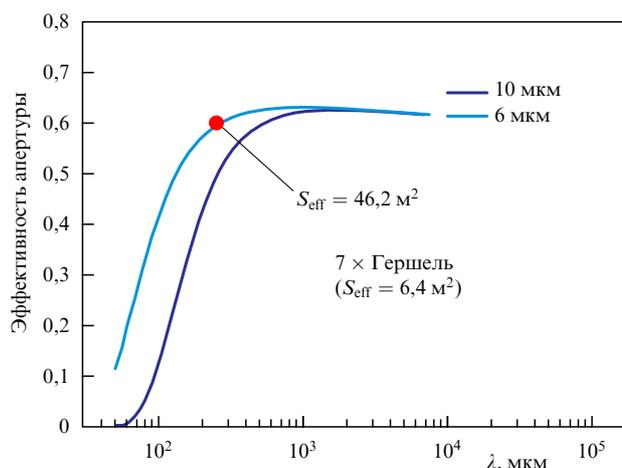
**Рис. 2.** Эффективность 10-м зеркала обсерватории Миллиметрон в зависимости от длины волны при среднеквадратичной погрешности поверхности 6 и 10 мкм.
