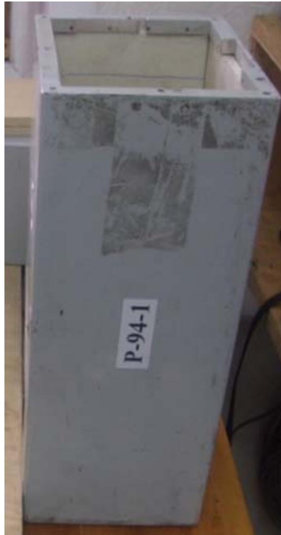
Трехмиллиметровый радиометр и его утеплённый корпус. Снаружи на передней стенке радиометра теплоотводы. На медном пластине нагреватель на 12 Вт и термодатчик. У рупора выходной диаметр 63 мм и диаграмма направленности 3.5 градуса. Флуктуационная чувствительность радиометра 0.08 градуса при постоянной времени 1 секунда.
